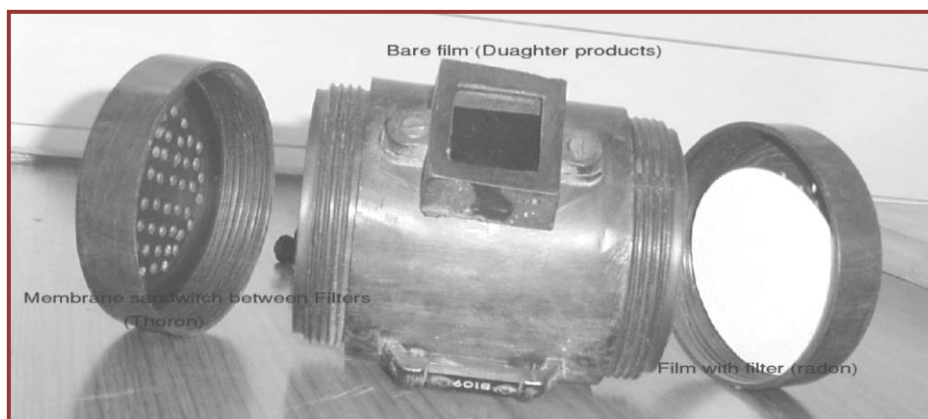
Fig: 2. Twin cup dosimeter in open mode
